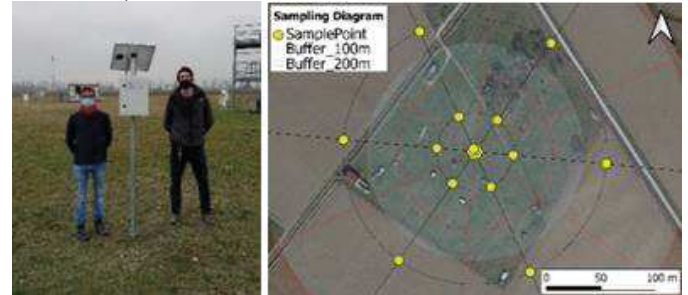
Fig. 2. (a) Tipica installazione del sensore CRNS e (b) disegno di campionamento di suolo per la calibrazione e area indagata dal sensore
