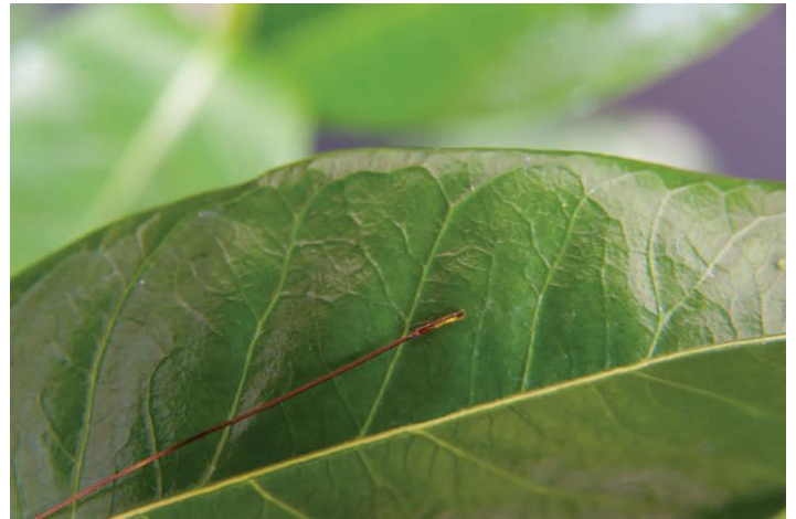
将叶片温度传感器安装于叶片表面
