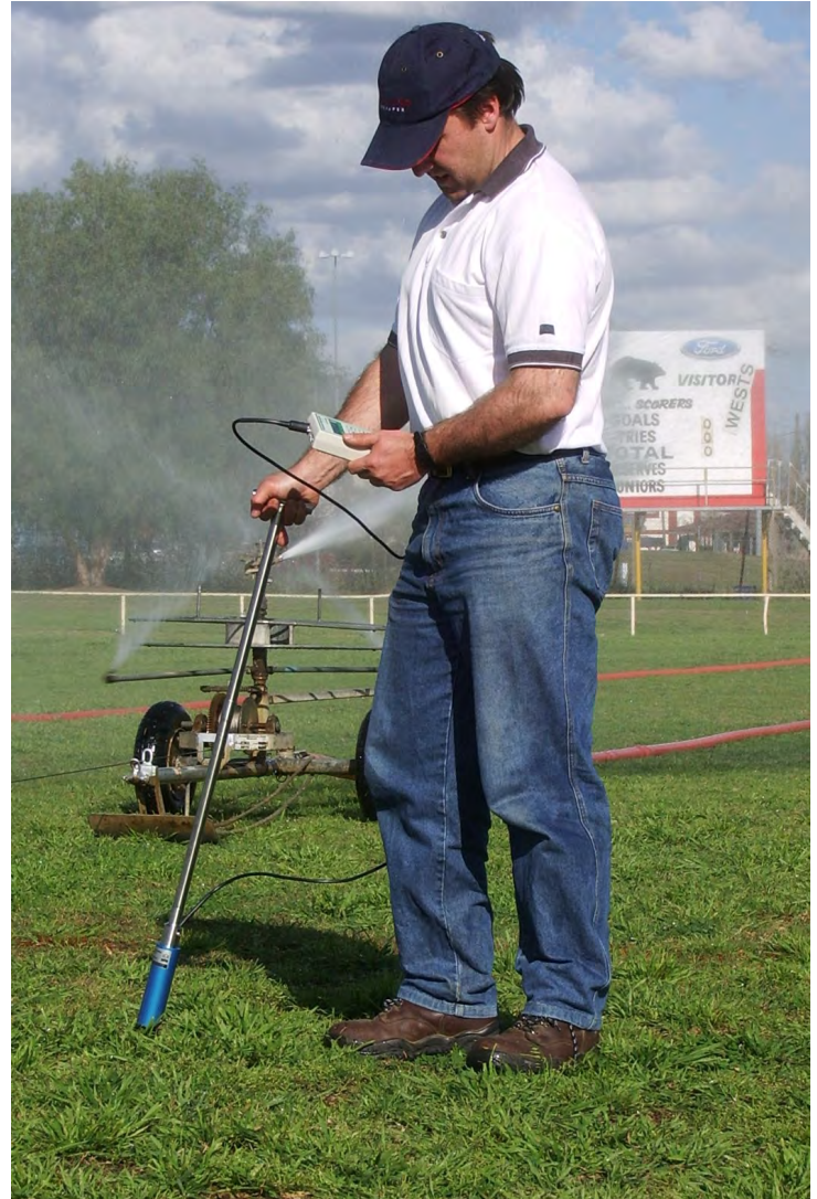
MPKit mengukur volumetrik lengas tanah permukaan
