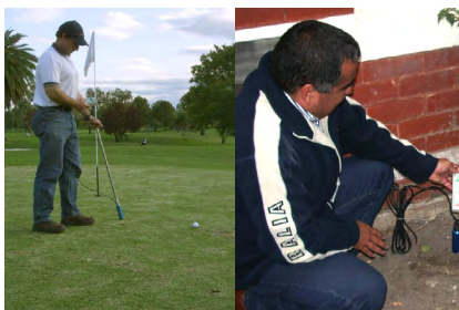
MPKit dapat dipakai untuk mengukur berbagai kedalaman lubang tanah
