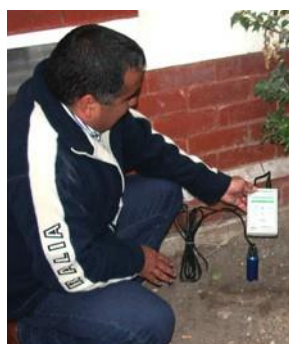
MPKit 可在土钻打出的任意深度的孔洞中进行测量
